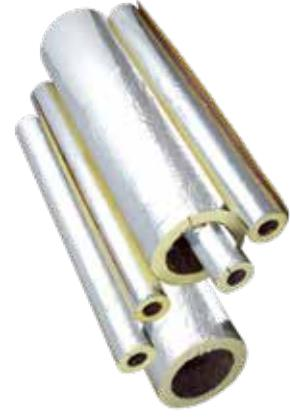
Alüminyum folyo kaplı, yüksek birim ağırlıktan camyününinden imal edilen borular olup sanayi borularının, kalorifer, merkezi ısıtma ve güneş enerjisi tesisi satılarının ısı yalıtmalarında, boruların terlemeye veya donmaya karşı yarımaya basınçlı su borularında tıreşime ve sese karşı kullanılır.
